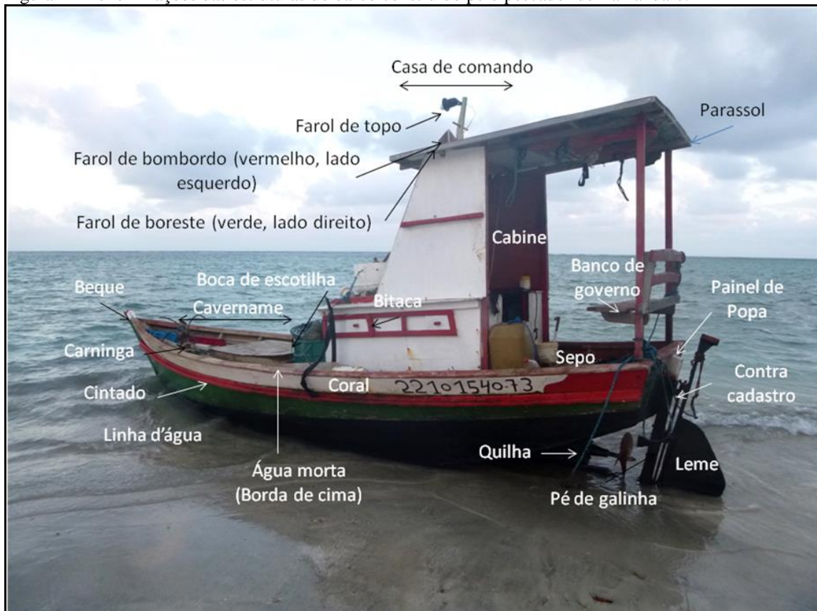
Figura 4 - Denominações das estruturas do barco construído pelo pescador de Tamandaré.
